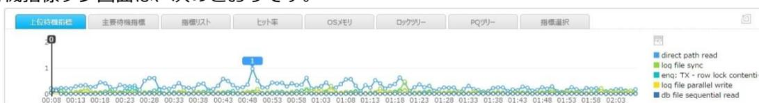
分析区間に発生した待機イベントの中で待機時間基準上位 5 待機イベントに対する推移グラフを表示します。
